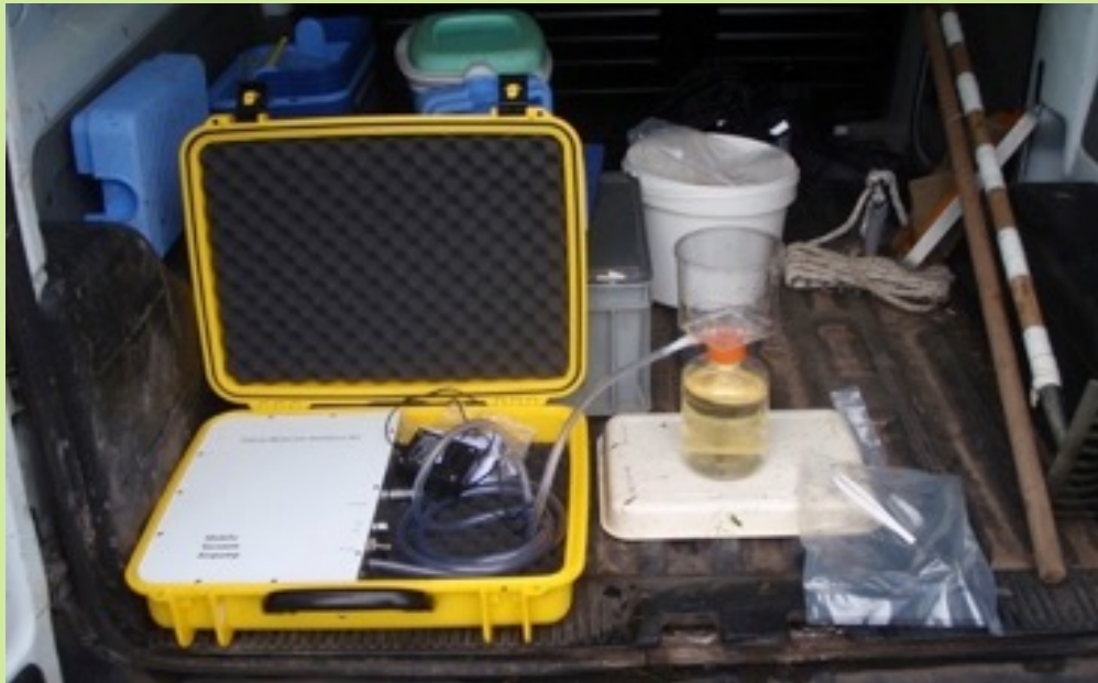
Foto mobiele filtratieopstelling ten behoeve van bemonstering eDNA achterin laadruimte van auto. Foto A. Kersbergen.
