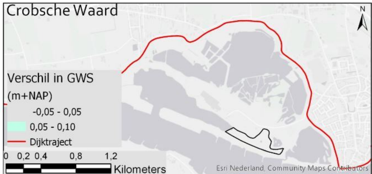
Figuur 6.39: Het effect van de strang op de stijghoogte in het eerste watervoerend pakket tijdens hoogwater.
