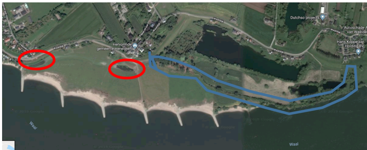
Figuur 6.43 Wensen vanuit de bewoners: verwijderen deel van de puinrug (blauwe lijn) en verbinden plassen met Waal (rode cirkels).
