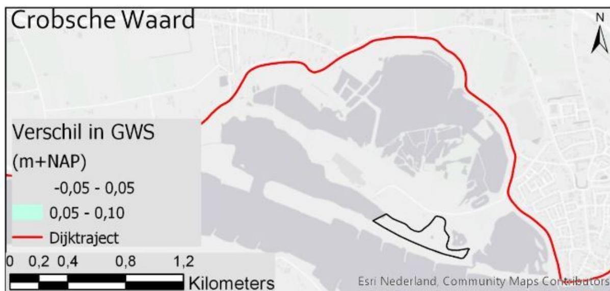
Figuur 6.8 Het effect van de strang op de stijghoogte in het eerste watervoerend pakket tijdens hoogwater.
